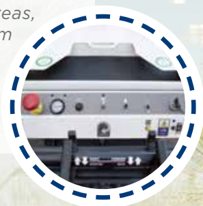
Sistema di avanzamento regolabile completo di regolatore di velocità e vano porta oggetti integrato
